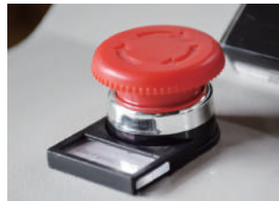
緊急停止スイッチを押した状態
