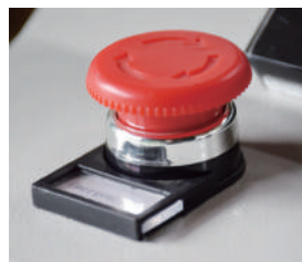
緊急停止スイッチを押した状態
