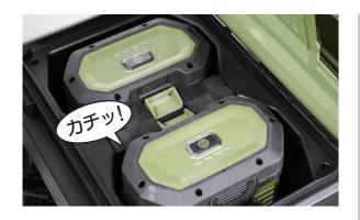
4 バッテリ挿入口カバーを閉じます。確実に閉めてください。
