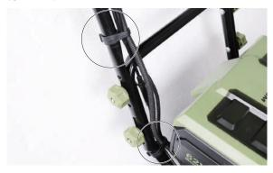
**5** 走行クラッチレバー、除雪クラッチレバーを固定している結束バンドを慎重に切断します。
