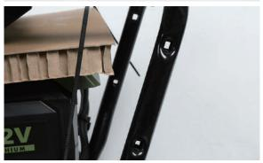
2 下ハンドルに上ハンドルをかぶせ、取付穴を合わせ内側からボルトを通します。このとき、3本のコードが下ハンドルの上に来るようにします。
