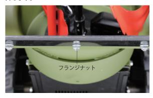
**4** ボルトを取外し、スクレーパーブレードを取外します。
