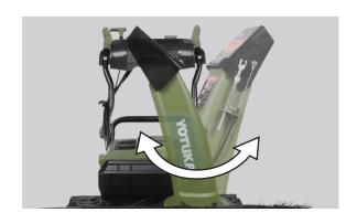
**4** シュータデフレクタ角度調整レバーを操作し、投 雪距離を調整します。(5 段階)
