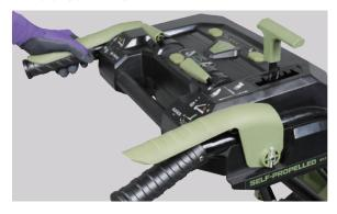
10 必要に応じて右手でオーガの回転速度、走行速度、投雪方向・角度の調整の操作をします。
