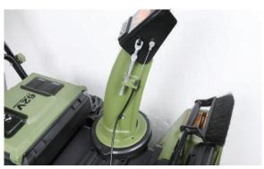
**3** 取付穴を合わせ、六角ボルトを取付け六角レンチで3ヵ所均一に締付けます。
