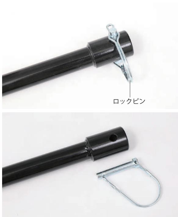
**2** 駆動軸にドリルを挿込み、取付穴を合わせます。
