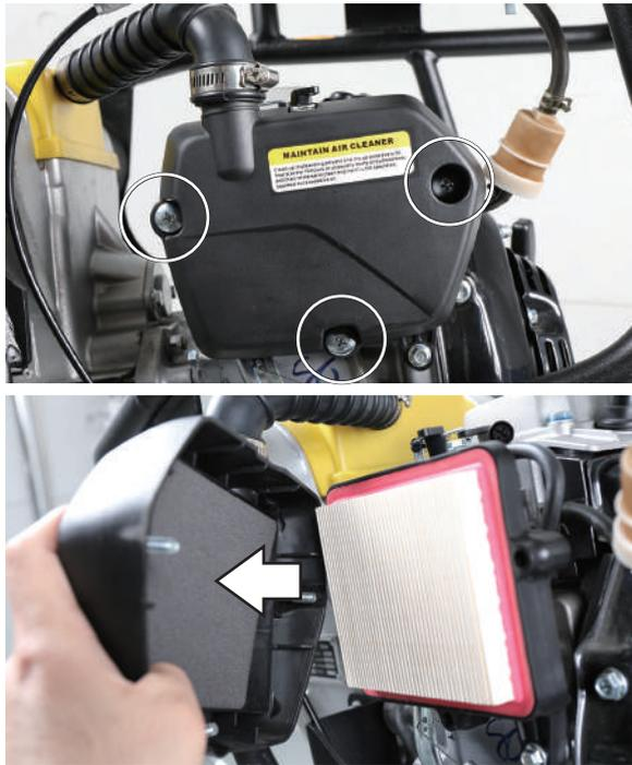
**4** 2つのエアフィルタを取り出し、汚れをエアブロー等で吹き飛ばします。ウレタン部の汚れがひどい場合は、中性洗剤入りのぬるま湯で丁寧に洗い、よく乾燥させます。
