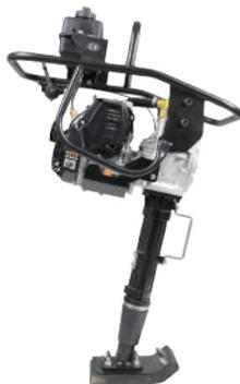
**3** 燃料タンクキャップを取外し、タンク内の燃料を手動のポンプ等で抜きます。
