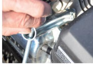
付属のプラグレンチで反時計回りで外します。振動等で緩まないよう少し固めに締め付けています。
