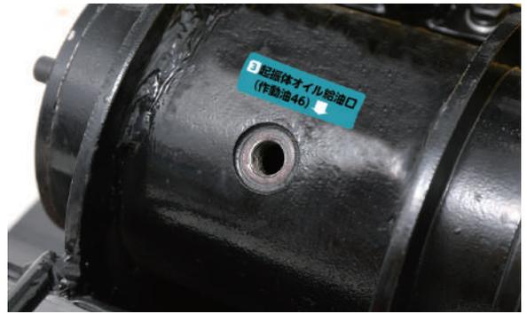
**3** 起振体横のドレンボルトを、14mm のスパナで反時計回りに回し取外します。
