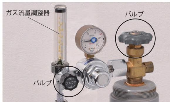
**18** トーチスイッチを押しながら、ガス流量調整器でガス流量を 4 ～ 7L/min (P.9 参照) に設定します。
