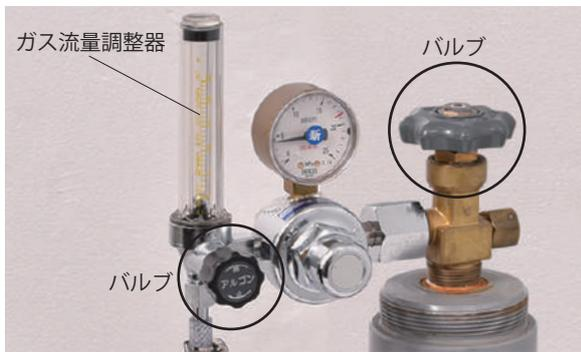
**23** トーチスイッチを押しながら、ガス流量調整器でガス流量を 4 ~ 7L/min (P.9 参照) に設定します。
