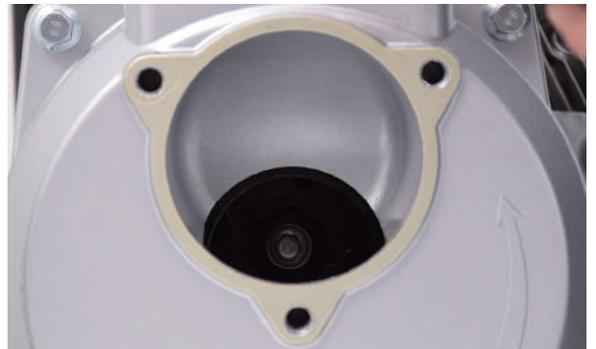
**3** 吸入口バルブにゴミなどの付着がある場合は取除き、亀裂などがある場合は、吸入口バルブを交換します。
