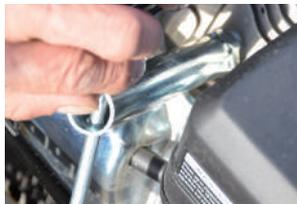
付属のプラグレンチで反時計回りで取外します。振動等で緩まないよう少し固めに締め付けています。
