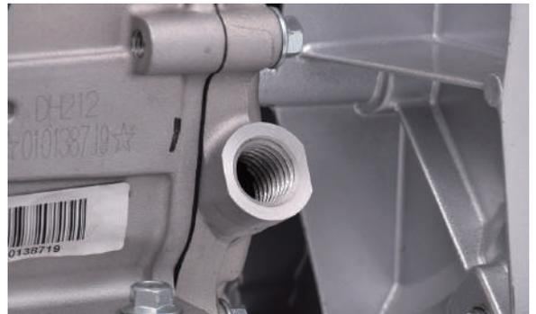
**3** オイル給油キャップを取付け一旦締付け、再度外します。
