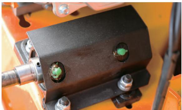
**3** 注入すると接続している各シャフト部分ベアリングからグリスが漏れてきたら、注入完了です。注入量は、合計約 400ml です。
