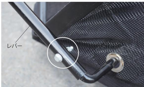
**5** 本体後方の下側のボルトを取外します。
