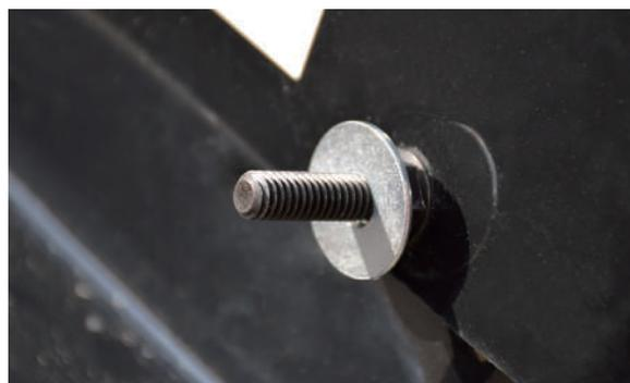
**9** 本体後方の上側の穴に付属のボルト、ワッシャ、ナットを取付けます。(仮留め)
