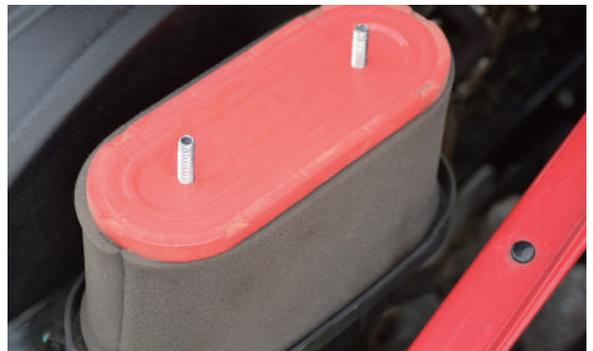
**2** エアフィルタの汚れを、エアガン等で吹き飛ばします。
