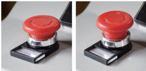
緊急停止スイッチが 押された状態
