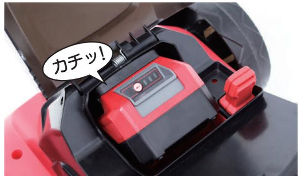
**4** バッテリー挿入口カバーを閉じます。
