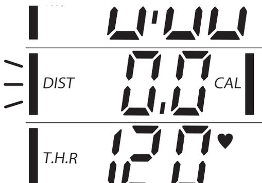
**4** 距離を設定したい場合は、「DIST（距離）」が点滅しているときに「上」ボタンを押し、距離を設定します。長押しすると速く進みます。「下」ボタンを押すと戻ります。長押しすると速く戻ります。
