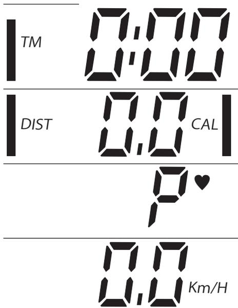
もう一度押すと設定モードに入り、「TM (時間)」が点滅します。押すたびに「DIST (距離)」→「CAL (カロリー)」→「T.H.R (目標心拍数)」の順で点滅します。点滅している間に数値の設定を行います。ボタンを長押し(約3秒)すると全ての数値をリセットします。
