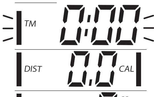
**2** 時間を設定したい場合は、「TM（時間）」が点滅しているときに「上」ボタンを押し、時間を設定します。長押しすると速く進みます。「下」ボタンを押すと戻ります。長押しすると速く戻ります。
