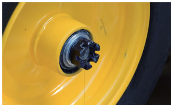
モンキーレンチで締付ける
