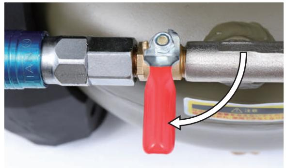
2 カプラーのリングをスライドさせるとエアホースが外れます。この時、ホース内のエアが完全に抜けきらない状態で行うと、エアホースが勢いよく外れる場合がありますので、完全にエアを抜いてください。また、念のためホース側も手で持つて行ってください。
