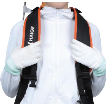
**3** 左右のベルトを下に引っ張り調整します。
