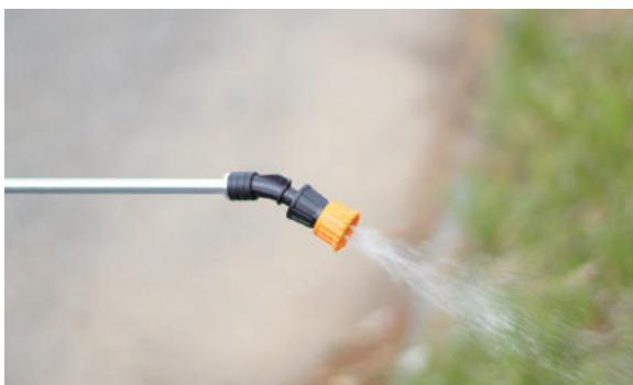
3 薬剤タンク内の水を抜き、再度運転をし、ノズルから残液が出なくなったらレバーを放します。
