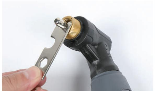
**4** チップ、電極に欠けやひび割れがないか確認します。
