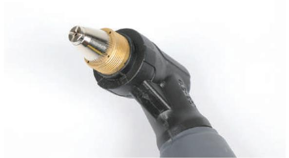
**3** 専用工具でノズルを取外します。
