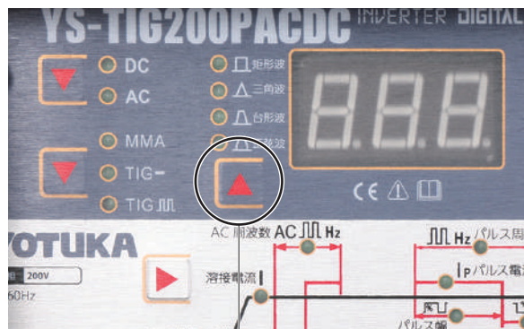
矩形波 / 三角波 / 台形波 / 正弦波切替ボタン
