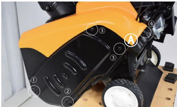
**3** 中央のプーリーを押すことで、①のベルト外れ留め部分が動き、ベルトが外しやすくなります。
