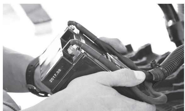
4 バッテリ端子との接続が、しっかりと固定されているか点検します。
