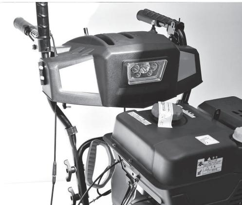
**2** 操作パネルハンドルの取付穴と中ハンドルの取付穴を合わせ、内側からボルトを通します。
