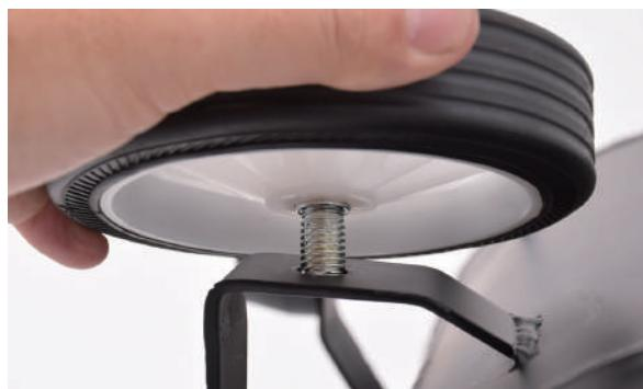
7 上部ネジ部を大型のプラスドライバーで固定しながら、13mmのスパナでナットを締付けます。
