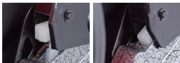
ブレーキがかかっている状態 ブレーキが解除された状態
