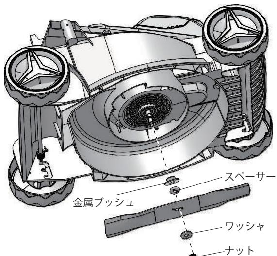
5 木片などを使用しブレードの動きを止め、インパクトレンチ又はソケットレンチでナット、ワッシャを取り外します。(反時計回りで緩みます。)
