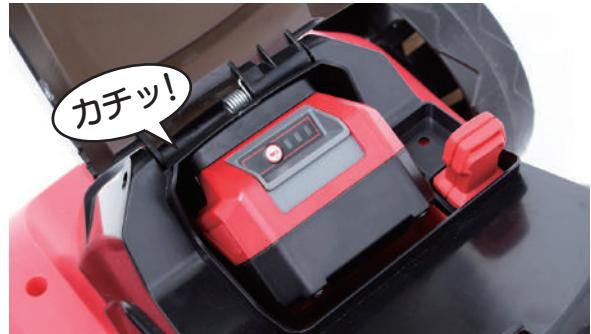
**4** バッテリ挿入口カバーを閉じます。
