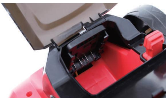
**2** バッテリパック挿入口の溝にバッテリパックを合わせ、スライドさせ挿込みます。
