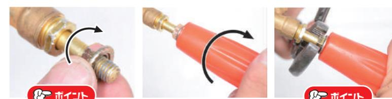
**1** ノズルのナットを指で止まるところまで時計回りに回します。
