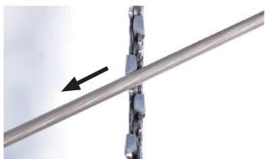
5 上刃よりデプスゲージが下にあることを確認します。上刃が摩耗し、デプスゲージの方が高くなった場合は、平ヤスリでデプスゲージをヤスリがけし低くします。
