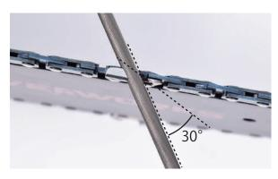
4 目立て開始箇所に目印を付け、片側を1周すべて 目立てを行い、次に反対側の目立てを行いま す。すべての刃を同じ角度でヤスリがけするこ とが重要です。
