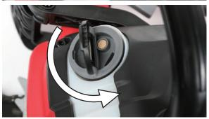
**2** タンクが空の場合はチェンソー専用オイルを 「最大150ml」を給油します。満タンで約20~ 40分使用可能です。給油後はオイルキャップを しっかり締めてください。
