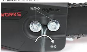
2 ソーチェンの張りは、ガイドバーとの隙間が出 ないように張ります。チェンオイルを入れた 後、エンジンをかけ、チェンを回した時にたる みがあれば、張りの調整をします。
