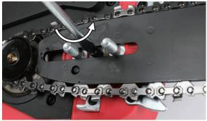
**8** ソーチェンが外れない程度に張り調整ネジを締付けます。
