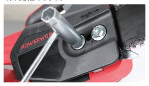
10 ソーチェンの張りの調整を行った後にチェンカバーナットを均等に締付けます。(ソーチェンの張りの調整 P.14 参照)
