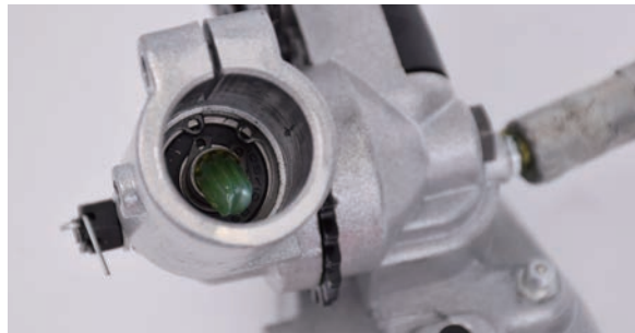
グリス注入器のチャックノズルでの注入
