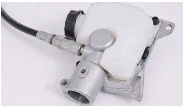
グリス注入器のチャックノズルでの注入
