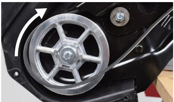
3 中央のブーリーを押すことで、①のベルト外れ留め部分が動きベルトが外しやすくなります。
