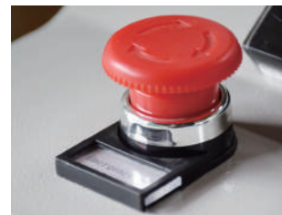
緊急停止スイッチを解除した状態
