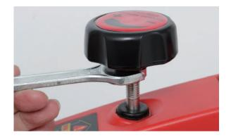
**3** 使い始めの時は、テンションノブの軸とゴムキャップの摩擦が大きいため、ノブを押した時に、「キュッキュッ」と音が鳴る場合があります。
