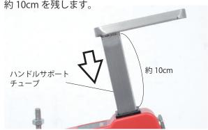
**3** 高さ調整レバーハンドルを時計回りに回し取付けます。
