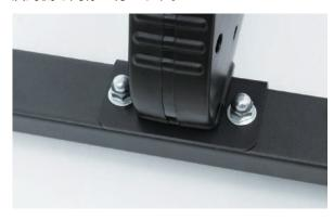
4 底側のボルトを 14mm のスパナで押さえながら、 上のキャップナットを 16mm のスパナで締付け ます。左右均等に締付けます。
