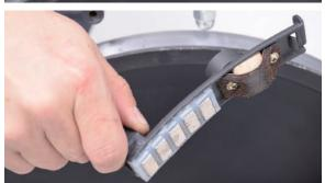
10 ネジを外し、ブレーキパッドを外し、新しいブレーキパッドと交換します。
