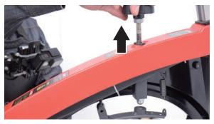
**9** マグネットステーをずらします。(強力マグネットのため少しずつずらして外します。)
