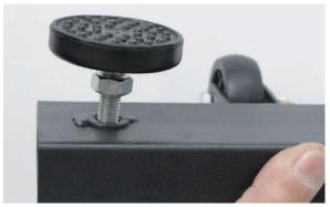
2 17mm のスパナでナットを締付けます。 ただしこの作業は全て組み上がり、実際に床に設 置した際に行うため、現時点では軽い締付けで問 題ありません。
