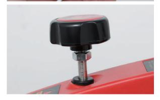
2 17mm のスパナでナットを締付けます。
