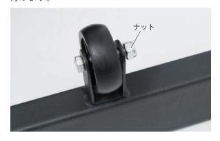
**3** ボルトを 12mm のスパナで固定しながら、 13mm のスパナでナットを締付けます。(ネジ山 2つ分が飛び出るくらい)
