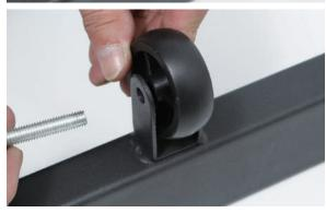
2 外側からボルトを通したら、反対側にナットを取 付けます。
