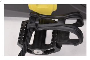
**8** 左クランクアームにペダル(左)を反時計回りに回し取付けます。
