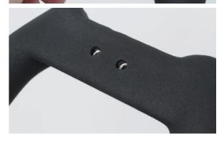
**2** メーターステーを取付け、六角ボルトを取付け締付けます。
