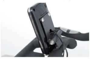
**7** メーターの角度を調整し、六角レンチと 10mm のスパナで締付けます。
