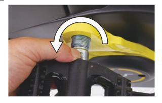
10 19mm のスパナで締付けます。この時抵抗を感じたらスパナを逆回しにし、一旦緩め再度締め直してください。無理に行うとネジ山を潰してしまい使えなくなります。
