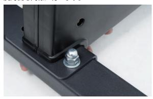
**4** 底側のボルトを 14mm のスパナで押さえながら、 上のキャップナットを 16mm のスパナで締付け ます。左右均等に締付けます。
