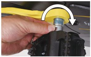
5 19mm のスパナで締付けます。この時抵抗を感じたらスパナを逆回しにし一旦緩め、再度締め直してください。無理に行うとネジ山を潰してしまい使えなくなります。
