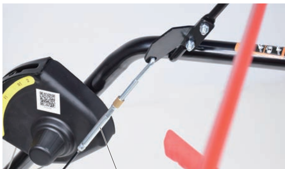
押さえながら、金色の留めナットを締める
