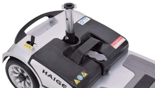
**2** シートサポートのボルト、ナットを 8mm の六角レンチと 17mm のスパナで外します。
