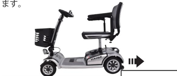
**4** 後進で段差を降りる時にバランスを崩しやすく転倒のリスクが高まります。補助輪が衝撃を和らげるだけでなく、転倒のリスクを低減します。
