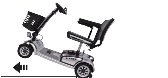
**2** 前進で段差を降りる時にバランスを崩しやすく転倒のリスクが高まります。補助輪が衝撃を和らげるだけでなく、転倒のリスクを低減します。
