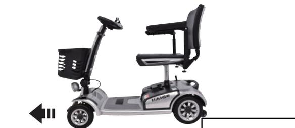
**3** 後進で段差を乗り越える時にバランスを崩しやすく転倒のリスクが高まります。補助輪が衝撃を和らげるだけでなく、転倒のリスクを低減します。
