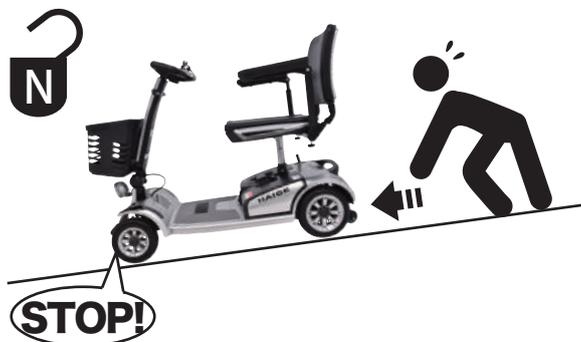
※スピードを出し過ぎると安全装置が働き、移動途中でブレーキがかかります。車両を完全に停止した状態で2秒待つと、再度移動ができますようになります。ゆっくり手押しするとブレーキはかからずに移動ができます。
