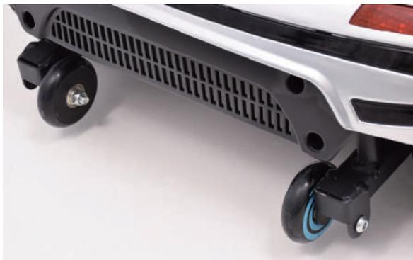
**1** 前進で段差を乗り越える時に、補助輪があるため、後ろへの転倒のリスクを低減します。
