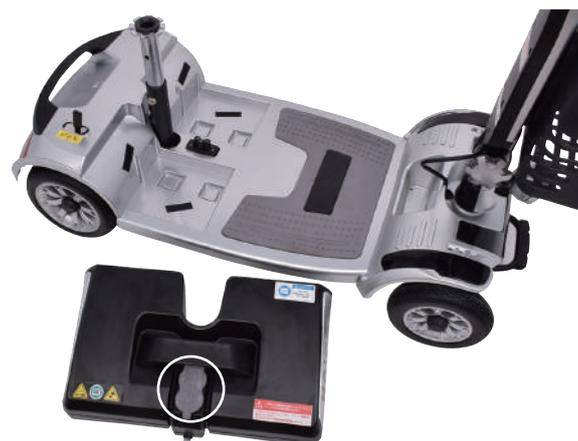
**2** バッテリーボックスのカバーを開き、3 ピンの充電器ソケットに充電器のコードを挿込みます。
