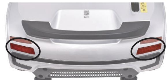
**⑤⑥** 方向指示器ボタン・・・左のボタンを押すとフロントとリアの左の方向指示器が点滅します。右のボタンを押すと右が点滅します。消し忘れ防止のため、それぞれ約12回点滅し消灯します。
