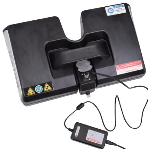
**3** 充電器の電源プラグをコンセントに挿すとオレンジ色のランプが点灯します。
