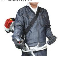
**3** 刈刃の高さが、地面から10cm位になるようにストラップの長さを調整します。
