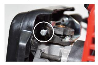
2 アイドリング時に調整スクリュを反時計回りに 回すと、回転が下がり刈刃が回転しなくなりま す。調整スクリュを時計回りに回すと回転数が 上がります。
