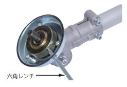
4 刃受け金具の凸部分に、刈刃の穴がずれないように、刃の向きに注意して置き、刃押さえ金具、ナットカバーの順で置いて、取付けナットで締めます。
