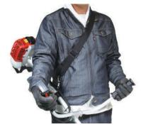
**3** 刈刃の高さが地面から10cm位になるように肩掛けバンドの長さを調整します。
