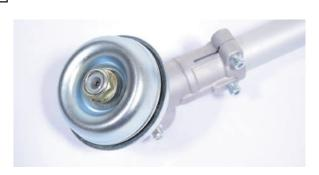
2 ギヤケースの穴に六角レンチを差込み固定し、ボックスレンチで取付けナットを時計回りに回して刃押さえ金具、ナットカバーを取外します。
