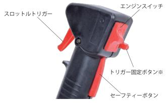
※トリガー固定ボタンは基本的に使用しません。エンジンが始動しない時、刃を外してスロットルを開いて始動する時のみの点検用として使用します。また、トリガー固定ボタンを押した状態では、エンジン全開にはなりませんので、刈払作業に使用することはできません。
