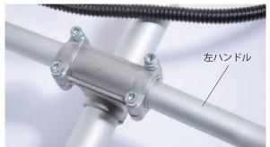
3 ハンドルを使いやすい角度に調整し、4本の取付けボルトを均等に締め、ハンドルを確実に取り付けます。
