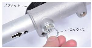
2 ロックピンを引っ張りながらメインパイプが本体パイプに突き当たるまで挿込み、ロックピンがメインパイプの穴に入ったら指を放します。 確実に接続されたかメインパイプを引っ張り確認します。
