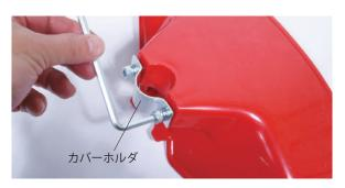
2 飛散防止カバーの凹み部分をバイプにはめ込み、カバーホルダで挟み込むように取付けボルトを上部カバーホルダから通し、飛散防止カバーを確実にメインパイプに取付けます。
