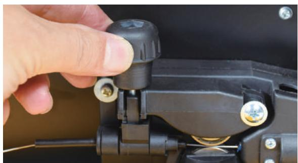
8 ワイヤをガイドローラーの溝に入れ、穴に挿込みます。※溝は0.8mmと0.9mmの2種類があります。ワイヤが0.8mmの場合は0.8mmの溝を使用します。 (P.17参照)
