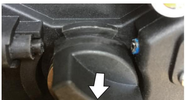
**3** ガイドローラーを引っ張ると簡単に抜けます。写真の向きが0.8mmで反対側が0.9mmです。
