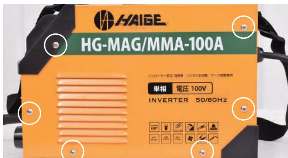
2 底部の角1ヵ所のネジを外します。
