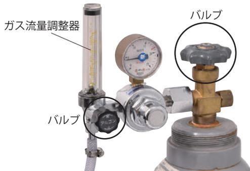
**14** トーチスイッチを押しながら、ガス流量調整器でガス流量を4~7L/min (母材厚による) に設定します。
