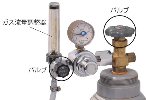
**23** トーチスイッチを押しながら、ガス流量調整器でガス流量を5L/minに設定します。
