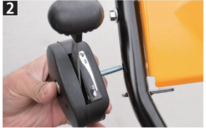
2 アクセルボックスに仮留めしているナット、平ワッシャを一旦外します。
