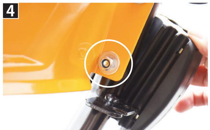
4 裏側から平ワッシャを通し、ボルトを取付け、10mmのスパナで締付けます。
