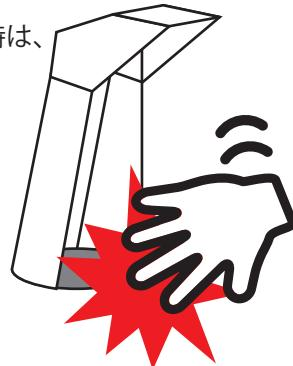
1 エンジンを停止させ、ラバーオーガの回転が完全に停止したことを確認します。
