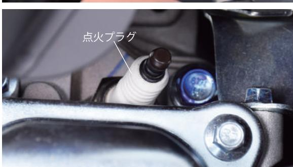
**3** 点火プラグをプラグレンチで取外します。（反時計回り）
