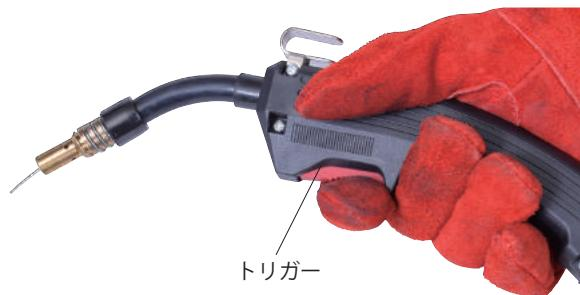
14 チップ取付け部より、50mm程度ワイヤが出てきたら、トリガーから指を放します。
