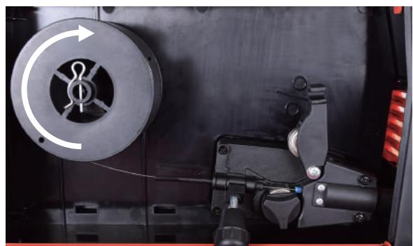
4 ワイヤが曲がっていたらその部分をニッパ等で切断します。ワイヤの先端を整えたら、再度ワイヤを送り出します。
