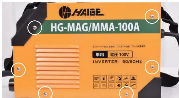
2 底部の角1カ所のネジを外します。
