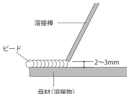
3 溶接棒の角度は進行方向に10°～30°程度倒します。
