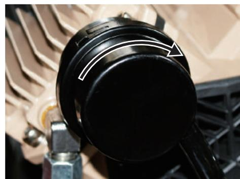
エレメントを戻し、フィルタカバーを押しながら時計回りに回します。
