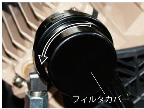
後ろのフィルタケースを固定しながら、フィルタカバーを押しながら反時計回りに回してカバーを外します。
